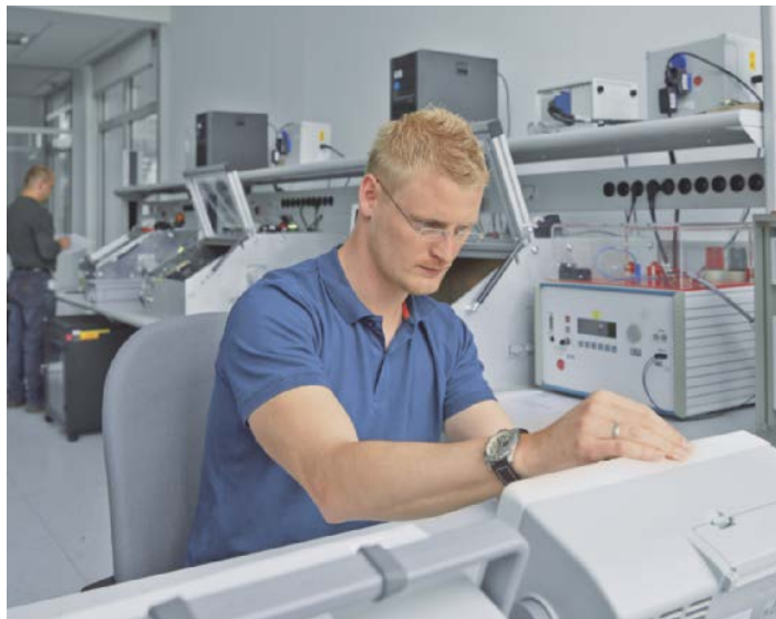
Ilustr. 26: Całkowicie automatyczny system kontroli do wyznaczania zachowania ograniczników przepięć w przypadku przeciążenia i uszkodzenia zgodnie z IEC 61643-11 [6]
