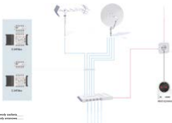
Przykładowy schemat instalacji antenowej z ogranicznikami C-SAT -Box oraz T3: MNT-NET B/F
